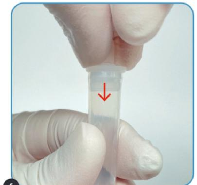
**f** Insérer l'embout avec filtre sur le tube d'extraction
