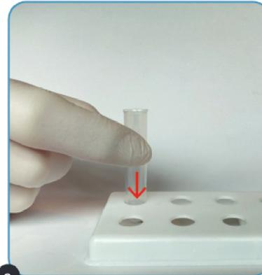
**a** Retirer l'opercule et insérer le tube d'extraction pré-rempli au fond du support
